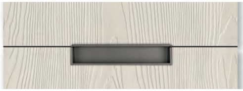
Maniglia 948S finitura silver dark anta L 15 → passo 64 mm anta da L 30 a L 45 → passo 160 mm anta da L 60 a L 120 → passo 320 mm
