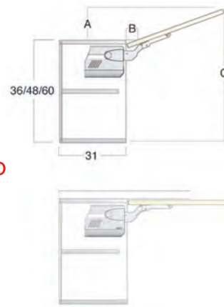
SCHEMA MONTAGGIO LIMITATORE PER RIBALTA H 36 FLAP DOOR LIMITER INSTALLATION DIAGRAM H 36
