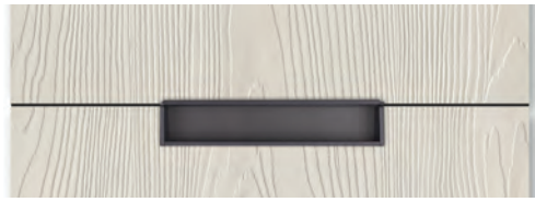
Maniglia 948G finitura ghisa anta L 15 → passo 64 mm anta da L 30 a L 45 → passo 160 mm anta da L 60 a L 120 → passo 320 mm
